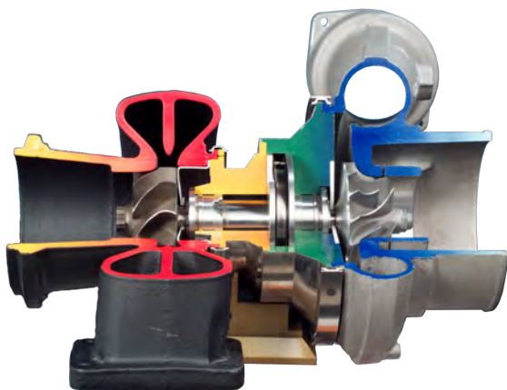
Kuva 1.8: Pakokaasuahntimen poikkileikkaus, punainen osa on turbiini, sininen osa kompressori [Turbocharger]
