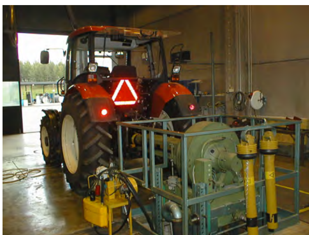
Kuva 1.10: Traktorin voimanottoakselitehon mittaus
